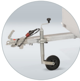
Gerade Rohrdeichsel bei einer Breite von 101 cm
