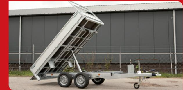
5-stufiger, sehr starker Zylinder, Kippwinkel 48° (bis 6100 kg)
